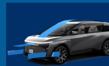
Model D 車身設計上融入 S 型進氣口與進氣簾等降風阻設計
